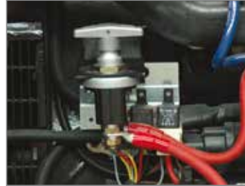
▲ Battery isolator switch Interrupteur coupe-batterie
